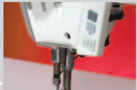
+ Neuer Dreifachttaster im Greifraum der Näherin: - Vorwärts/Rückwärts - Nadelhoch ohne Schneiden - Riegelaktivierung/ -invertierung - Einfädeltaste
