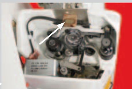
+ Funktionelle Spulenfadenüberwachung mit Resterkennung -926/06 (Option)
