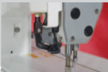
+ Der Fadenwischer -909/04 (Option) garantiert einen saubereren Nahtbeginn
